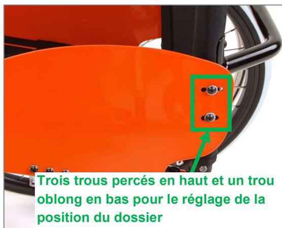
Figure 3 : Réglage de la position du dossier par les trous percés dans la tôle latérale
