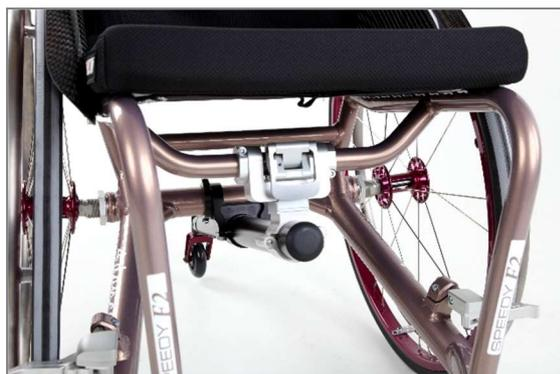
Figure 60 : Roulette anti-basculé centrale amovible (vue de l'avant)
