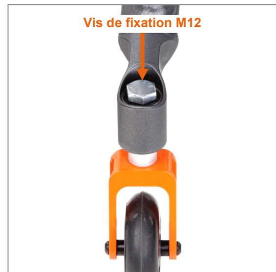
Figure 66 : Capuchon retiré et vis de fixation M12 visible
