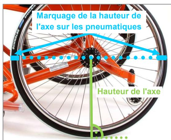
Figure 33 : Marquage de la hauteur de l'axe à l'avant et à l'arrière sur les deux pneumatiques
