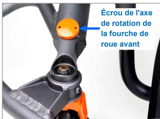
Figure 47 : Écrou entièrement retiré de l'axe de rotation de la fourche de roue avant
