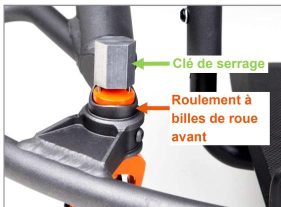
Figure 46 : Desserrage de l'écrou de l'axe de rotation de la fourche de roue avant avec clé de serrage
