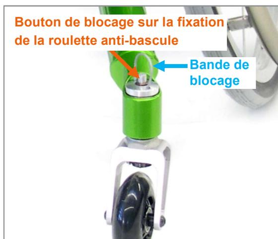
Figure 67 : Fourche de roulette anti-bascule avec axe à enficher
