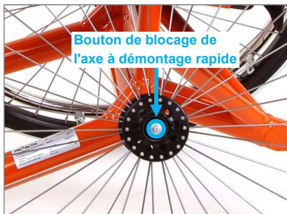
Figure 31 : Bouton de blocage de l'axe à démontage rapide au centre de l'axe de roue
