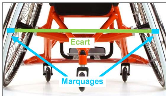
Figure 34 : Écart entre les marquages des pneumatiques (sur la hauteur de l'axe), à l'arrière
