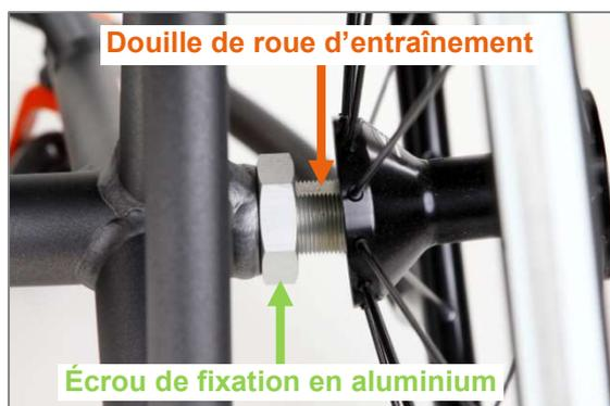
Figure 35 : Douille de roue d'entraînement et écrou de fixation en aluminium (vue arrière)
