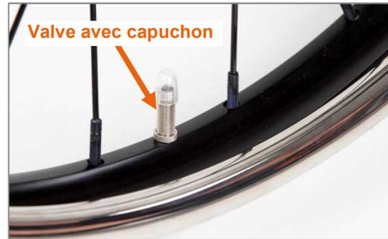
Figure 38 : Valve avec capuchon
