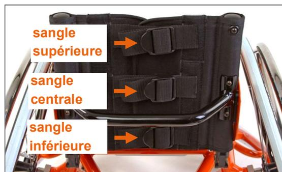
Figure 8 : Système de sangle de la toile de dossier adaptable avec trois sangles
