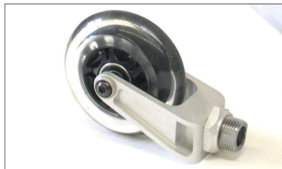
Figure 69 : Fourche de la roulette anti-bascule retirée
