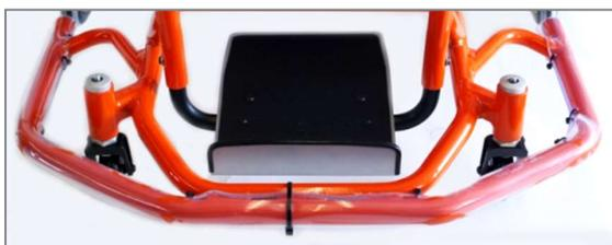
Figure 71 : Arceau Offence de forme trapézoïdale
