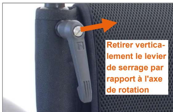
Figure 145 : Amener le levier de serrage dans une autre position angulaire en le retirant
