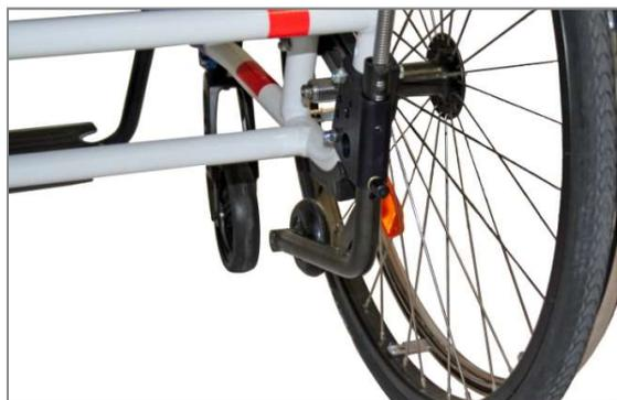
Figure 122 : Position passive des roulettes anti-bascule (vue arrière)
