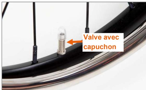
Figure 71 : Valve avec capuchon
