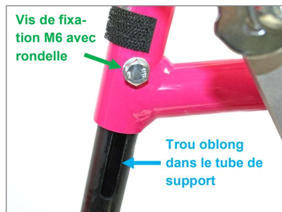
Figure 102 : Vis de fixation M6 avec rondelle et trou oblong dans le tube de support du repose-pieds pour le réglage de la longueur de potence
