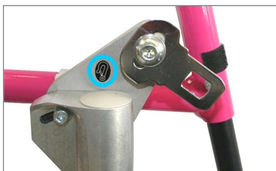
Figure 156 : Plaque d'écartement du roulement avec languette de fermeture pour le rétracteur avant
