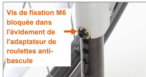
Figure 124 : Roulettes anti-bascule enclenchées correctement
