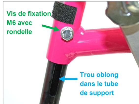
Figure 114 : Vis de fixation M6 avec rondelle et trou oblong dans le tube de support du repose-pieds pour le réglage de la longueur de potence
