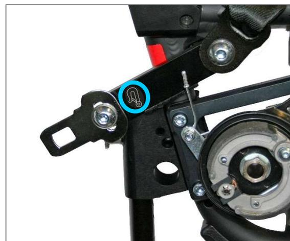
Figure 154 : Attache d'ancrage sur le châssis arrière avec la languette pour le rétracteur arrière et la ceinture ventrale
