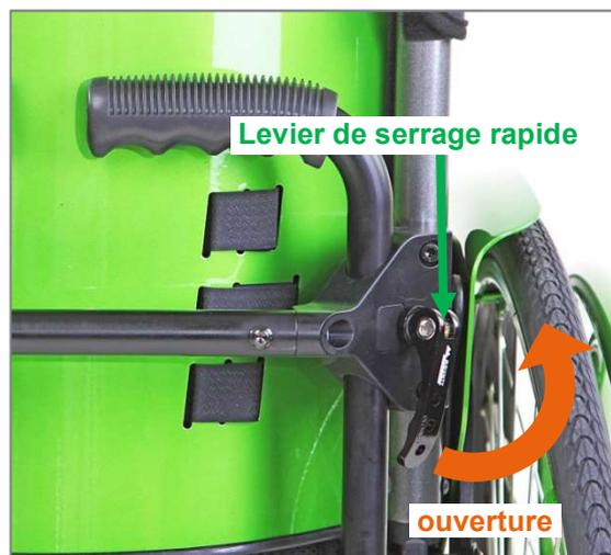
Figure 146 : Levier de serrage rapide fermé
