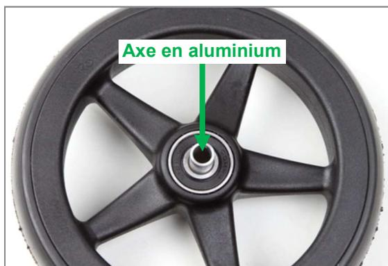
Figure 83 : Roue avant avec axe en aluminium
